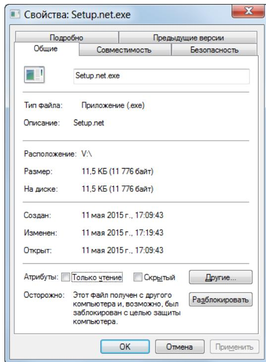
После снятия пометки с архива и последующей его распаковки все содержащиеся в нем файлы также будут извлекаться без пометки блокировки.
