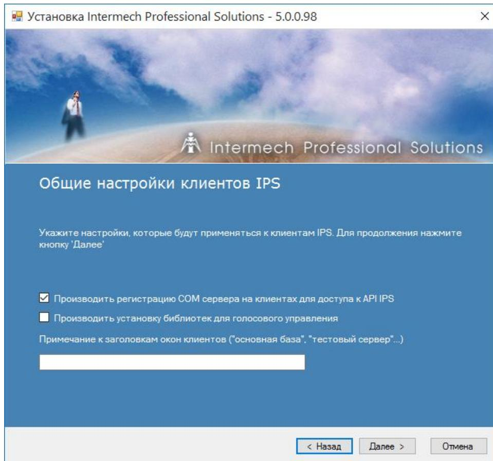
Параметр **Производить регистрацию COM сервера на клиентах для доступа к API IPS** позволяет разрешить доступ к API на клиентских машинах IPS. По умолчанию доступ разрешен.
