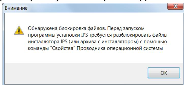
Данная проблема может возникать при загрузке инсталлятора IPS из сети **Интернет**. В этом случае операционная система помечает загружаемые файлы специальным образом для возможности последующего вывода предупреждений о потенциальной опасности запуска контента, полученного из сети **Интернет**.
