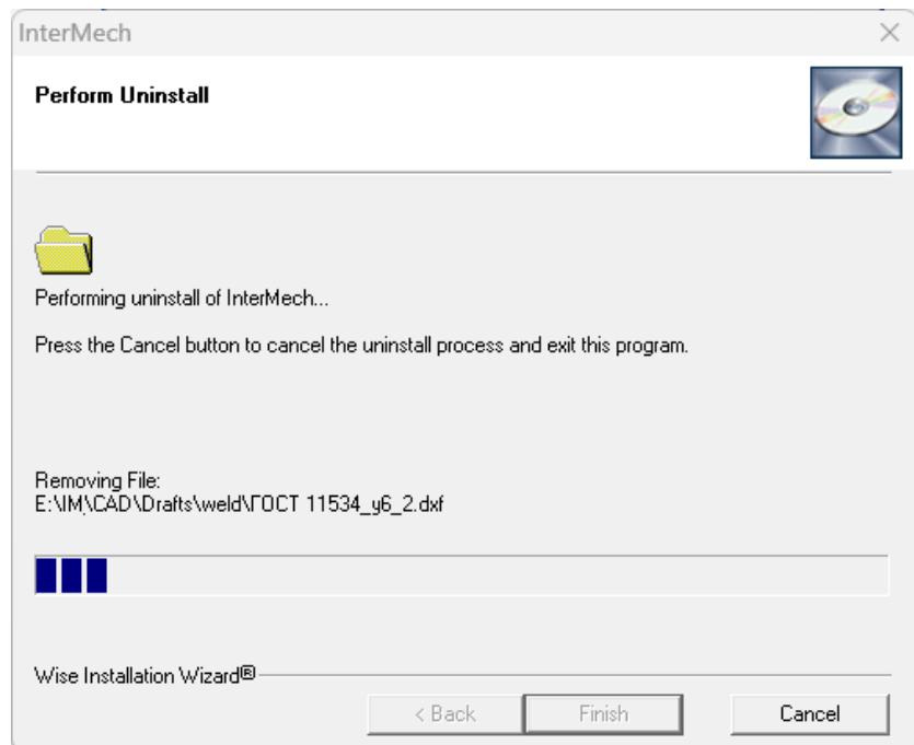
**Внимание!** Если на машине были установлены одновременно серверная и клиентская части IPS CAD Connector, то дополнительно нужно произвести запуск программы <папка с установленной серверной частью IPS>\IPS.InstClient\CADSystem\unwise.exe для удаления оставшейся серверной части IPS CAD Connector.
